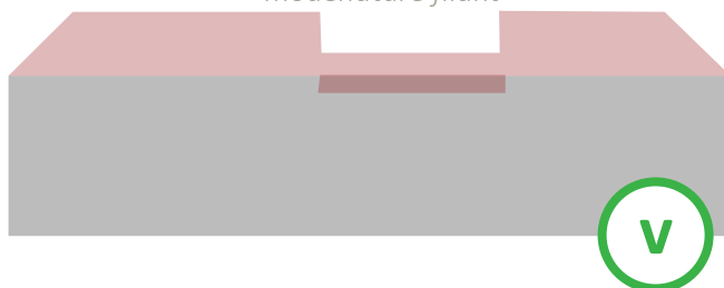
Décroché sans destruction d'un élément de modénature filant
