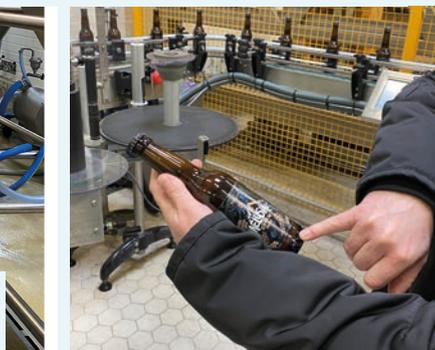
Une fois dans la cuve finale, les bières sont embouteillées ou enfutées sur une ligne mécanisée. Ainsi, 4 500 bouteilles par heure sont conditionnées.
