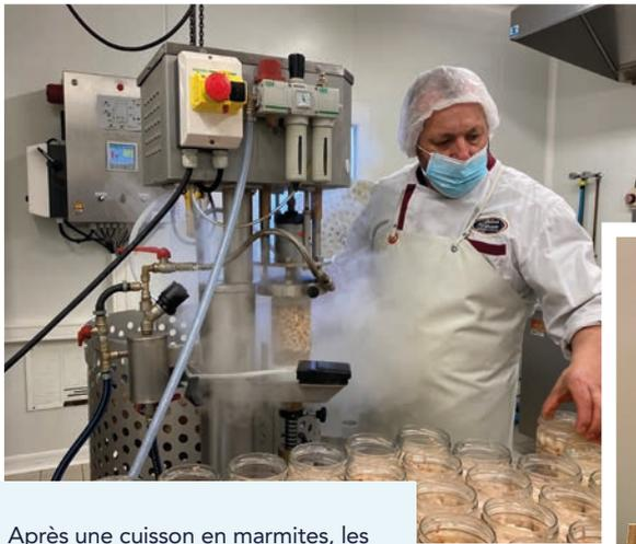
Après une cuisson en marmites, les conserves sont stérilisées grâce à la vapeur d'eau dans un appareil appelé autoclave, puis le couvercle est posé mécaniquement.
